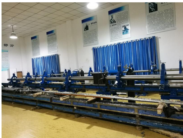
外-内径(145-75mm)新型霍普金森拉管系统
