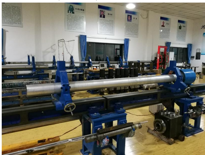
100~20mm 直径新型电磁式扭转脉冲加载装置
