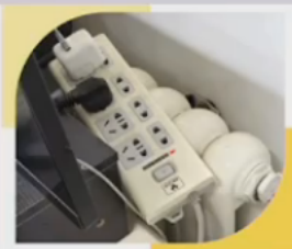
接线板放置于暖气、烘箱等热源或加热设备上
