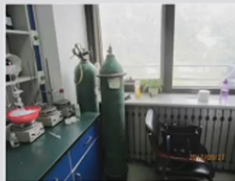
氢气瓶在室内、无检测
