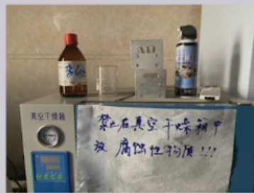
加热设备上放置易燃易爆化学品
