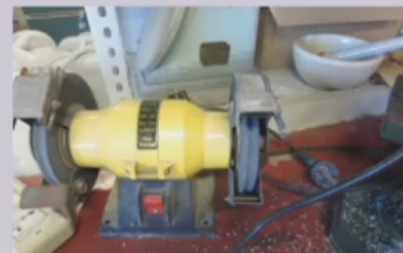
小砂轮机未固定，无安全标识， 无安全操作注意事项
