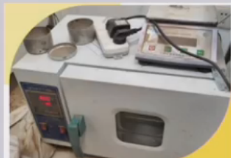
接线板放置于暖气、烘箱等热源或加热设备上
