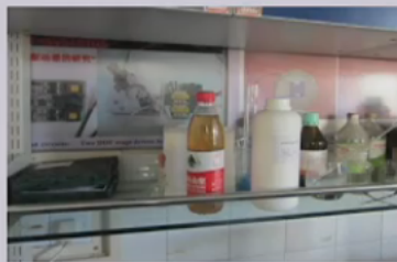
饮料瓶存放试剂，未撕去原包装 纸，未贴试剂标签
