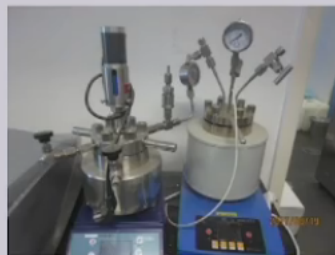
高压设备没有操作规程和警示标识
