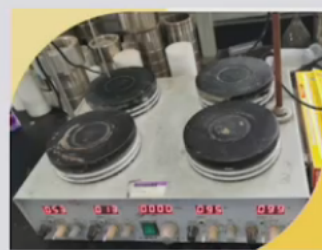
加热磁力搅拌器使用完毕，未关闭开关、未拔除插头
